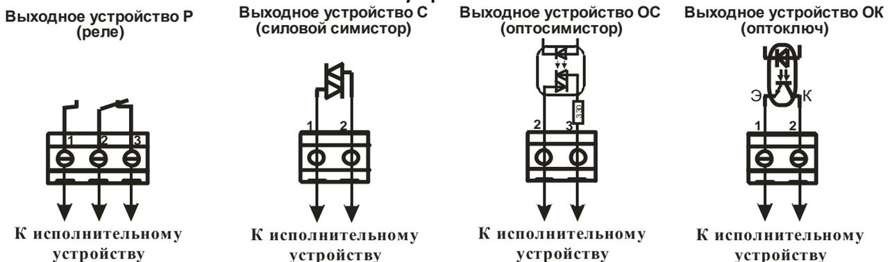
Рисунок 2 – Схемы подключения различных выходных устройств
